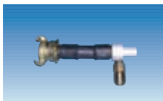
Art.-Nr. 1700018300 Vakuum-Adapter zum schnellen Entleeren des Stützgerüsts. Schnell- schlusskupplung an Luft- quelle anschließen, Druck sollte zwischen 4 und 6 bar liegen.
