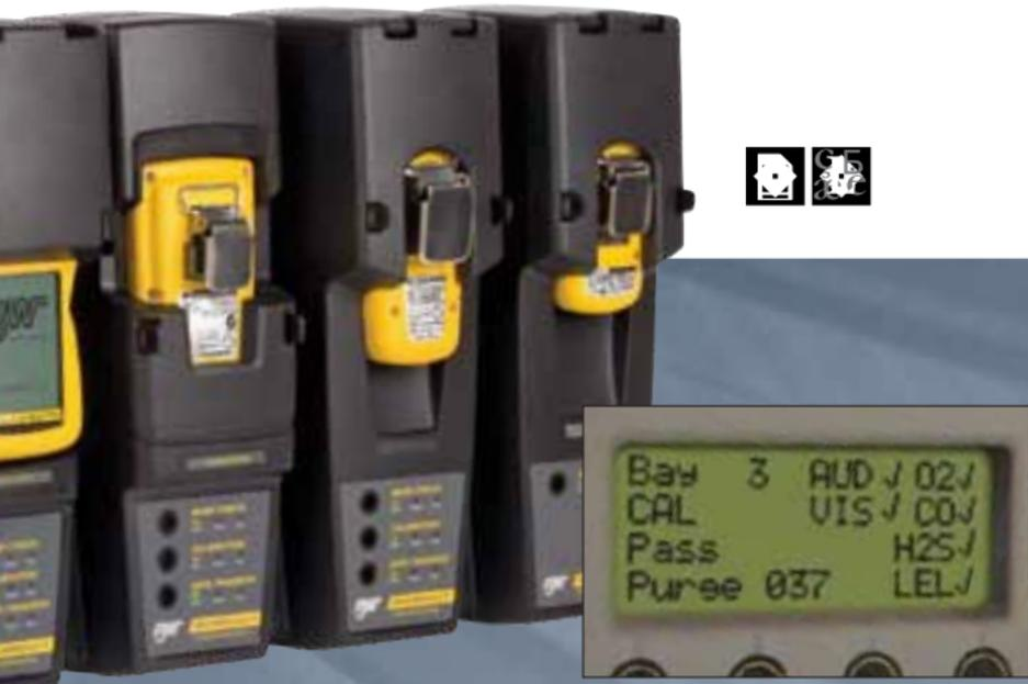
Der leicht ablesbare LCD-Bildschirm zeigt den Justierstatus und die Ergebnisse des Funktionstests für das Gaswarngerät an. Anzeige der Ergebnisse von Sensortests sowie der akustischen/optischen Alarme.
