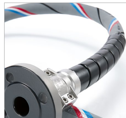
Knickschutzspirale KSS , mit passenden Spannloc-KSS-Schalen. Das patentierte System für eng gebogene Schläuche – zum Schutz des beanspruchten Bereiches direkt hinter der Armatur (siehe Elaflex-Information 2.09)
