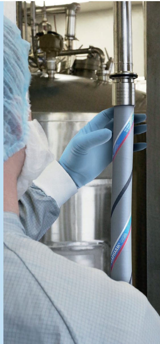
Einsatz des außen grauen, elektrisch leitfähigen ELAPHARM bei der BERLIN-CHEMIE AG
