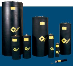
Rohr- und Prüfdichtkissen RDK/PDK zum Prüfen und Absperren von Rohrleitungen, sowie Um- und Ableiten von Flüssigkeiten. Aufgrund vielseitiger Anschlussmöglichkeiten sind Prüf- und Absperrblasen in den unterschiedlichsten Ausführungen und Nennweiten, DN 25 bis 2000 erhältlich Sanierungs- und Bogenpacker für die grabenlose Sanierung und partielle Reparatur von Abwasserleitungen, optional mit Fahrwagen und/oder Durchgang zum Um- und Ableiten von Flüssigkeiten
