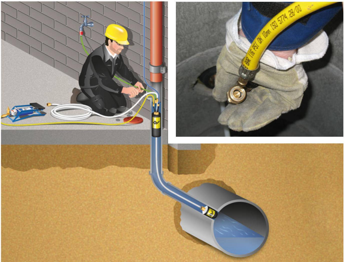
Wasserdruckprüfung gemäß DIN EN 1610 mit dem Vetter Hausanschlussprüfsystem
