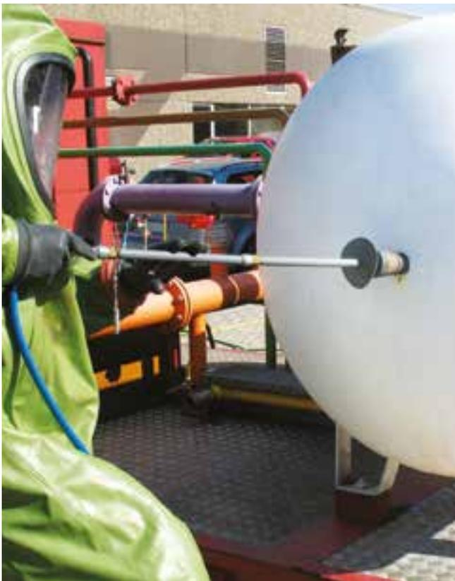
Dichten Sie Lecks aus sicherer Distanz ab
